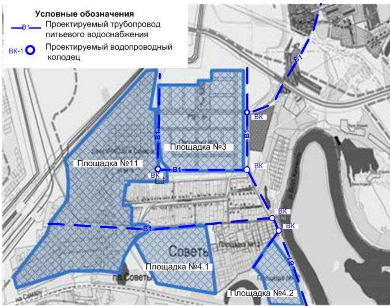
Рисунок 2.4.8.4 – Схема размещения планируемых объектов централизованной системы водоснабжения на территории п.г.т. Усть-Кинельский площадок №3, 11, перспективного строительства под жилую зону в районе п. Советы
