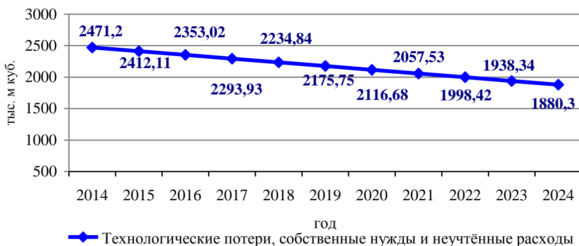
Рисунок 2.3.7.3 – Потери и неучтённые расходы воды на период 2014-2024 гг. без учета освоения площадок под новое строительство с учётом реконструкции существующих водопроводных сетей
