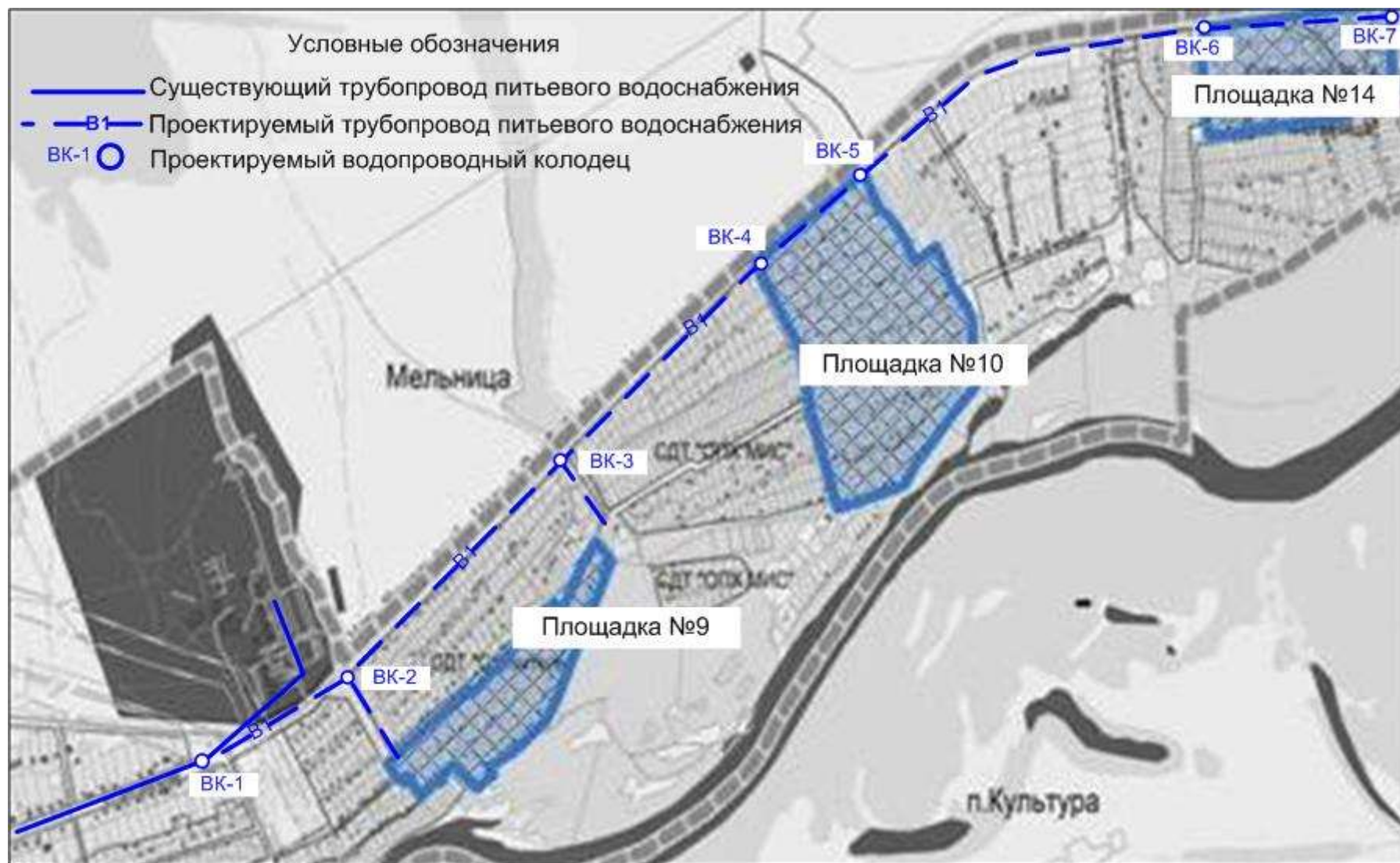
Рисунок 2.4.8.1 – Схема размещения планируемых объектов централизованной системы водоснабжения на территории п.г.т. Усть-Кинельский площадок №9, 10, 14 перспективного строительства под жилую зону
